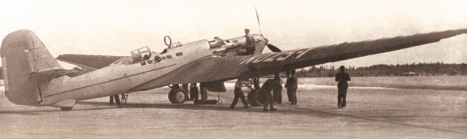
Героический АНТ-25, оснащенный двигателем АМ-34. Подготовка АНТ-25-1 к перелету. Щелковский аэродром
